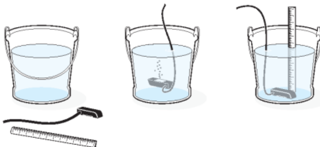
图 18 校准浸入式面积/速率传感器
